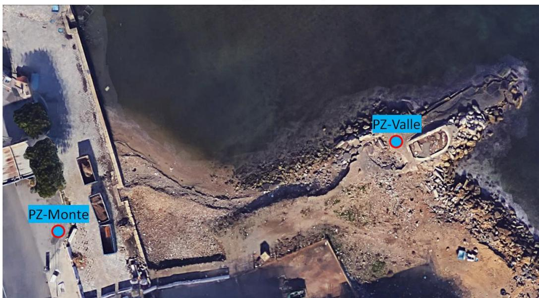
**Figura 37. Distribuzione spaziale dei piezometri di monte e di valle dai quali prelevare i campioni di acque sotterranee**
