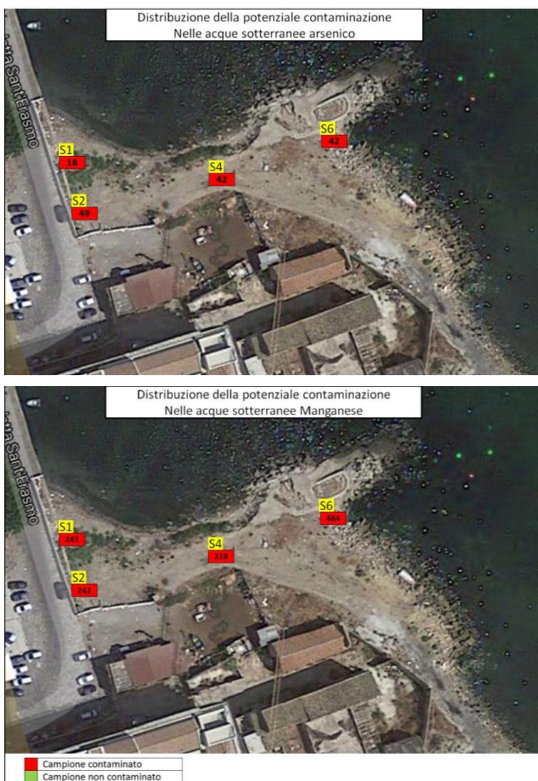
**Figura 7. Schematizzazione della contaminazione delle acque sotterranee per i parametri *Arsenico* e *Manganese***
