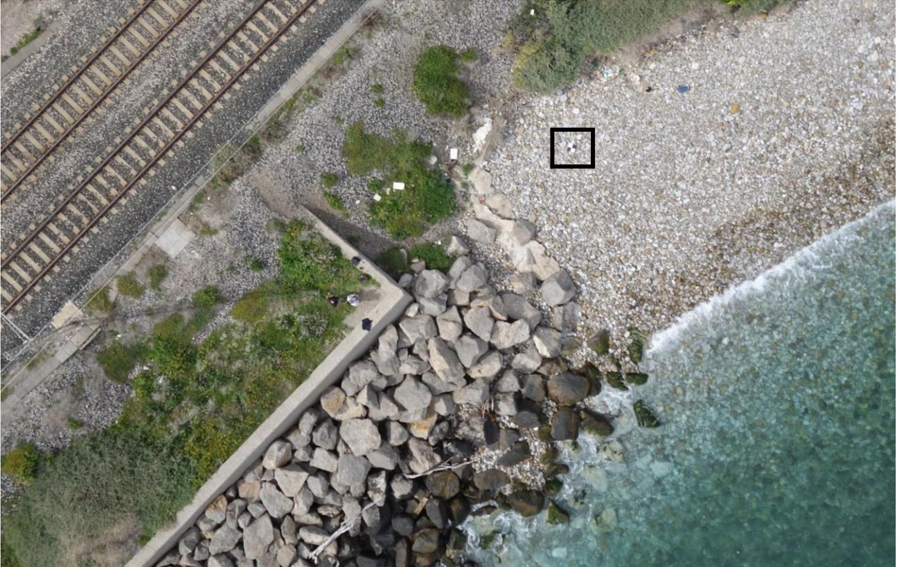
Figura 5– Foto acquisita dal SAPR in cui è stato evidenziato uno dei punti di controllo a terra utilizzati
