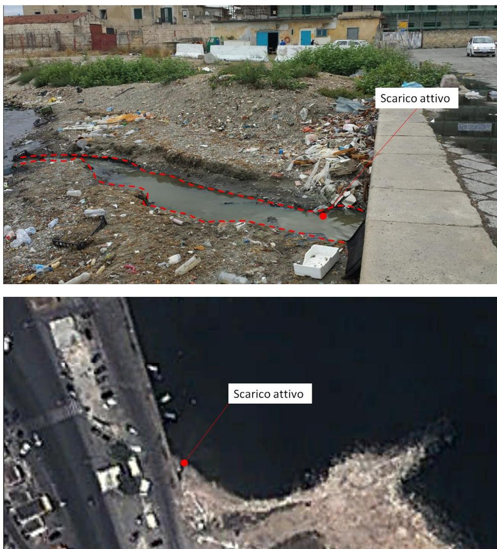
**Figura 22. In alto rilevamento fotografico del 2014 con evidente fenomeno di scarico di acque sull'arenile. In basso ortofoto del settembre 2012 con evidenza del fenomeno**
