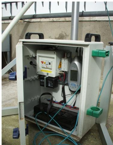
Fotografia interno centralina di rilevamento fonometrico SCS 9003.
