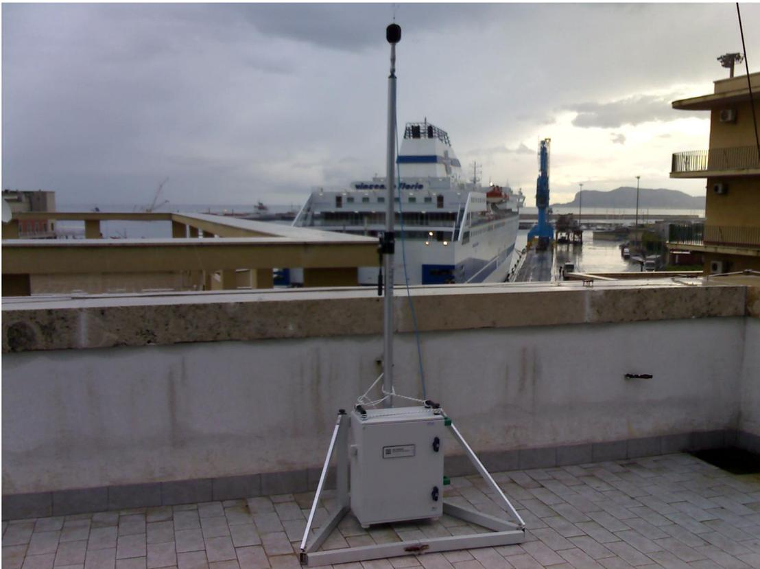
Fotografia di una centralina di rilevamento fonometrico SCS 9003.
